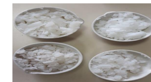
Рисунок 3 – Техуглерод, микросфера и кремнезем, полученные на установке
