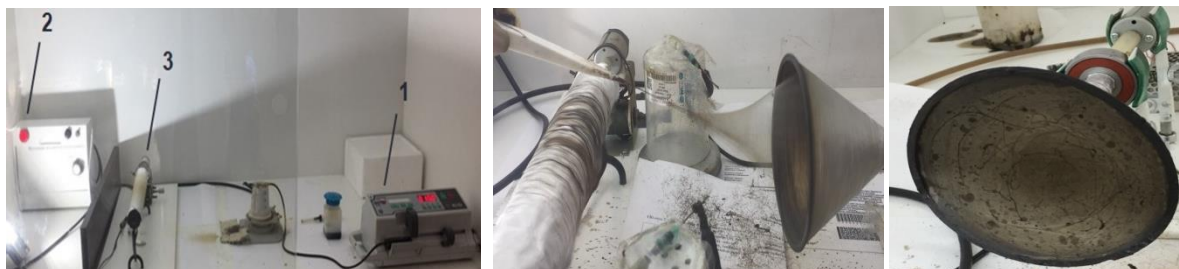
Рисунок 1 – Лабораторная установка электроспиннага
