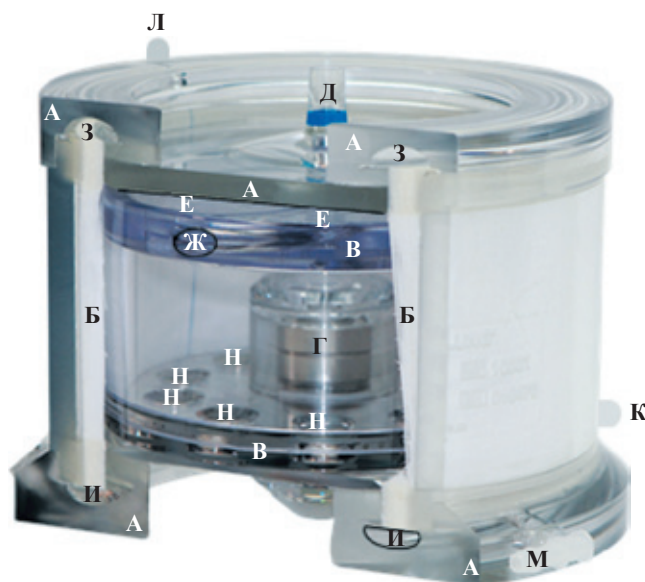
Рис. 2. Составные компоненты газообменного картриджа на разрезе: А – корпус газообменного картриджа; Б – газообменная полипропиленовая мембрана; В – встроенный вращающийся барабан; Г – подшипник; Д – верхний штуцер; Е – свободное пространство между корпусом и барабаном; Ж – каналы внутри барабана; З – канал для газа, поступающего в картридж; И – канал для газа, выходящего из картриджа; К – нижний штуцер; Л, М – штуцеры; Н – встроенные магниты
